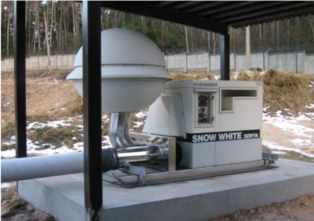
4. attēls Gaisa piesārņojuma kontroles iekārta SNOW WHITE (jaunā)
