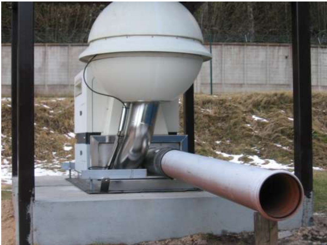
5. attēls Gaisa piesārņojuma kontroles iekārta SNOW WHITE (jaunā)
